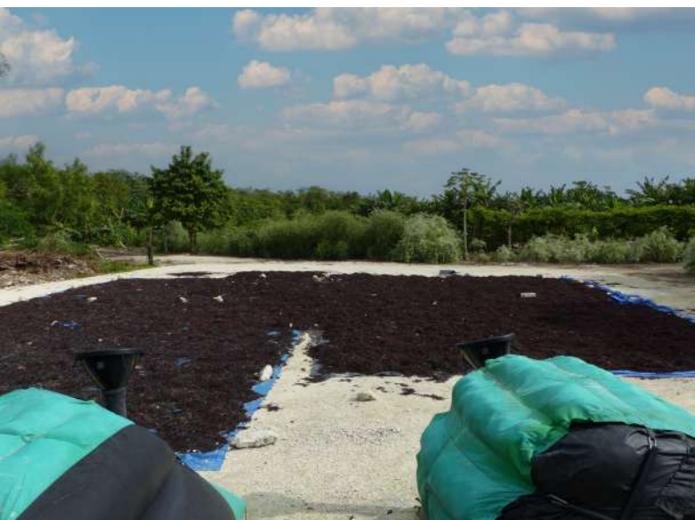
Figura 2. Biodigestores Home biogás 1.0 tipo bolsa, utilizados para las pruebas experimentales y sargazo en proceso de secado. Fuente: Unapec
